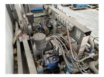
D-7440 Nurtin Kältemaschinen W.-Germ 01: Fuchs SP46 F.4 Typ Bj. 1990 Nr H20652 min1 Umin 13,97 m3/h nmin 500 Ungox 50,29 m3 /h aini wax: Betr - Uberdruck: 25 bar
